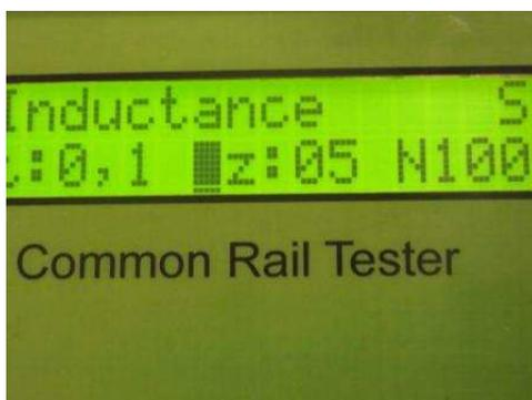
Для удобства оператора частота отображена не в герцах, а в секундах между импульсами срабатывания модулятора, запрограммированные значения «T» равны 0,2; 0,5; 1,0; 1,5; 2,0 сек. Переход на необходимое значение «T» производится нажатием на кнопки «-» или «+».
