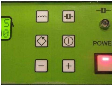
На экране электронного табло под знаком «t» (длительность импульса) появится мигающий курсор. В этом режиме оператор нажатием на кнопки «-» или «+» (левая и правая кнопки в нижнем ряду соответственно) может выбрать необходимую длину импульса из запрограммированных в модуляторе значений «t» = 1; 2; 5 мсек.
